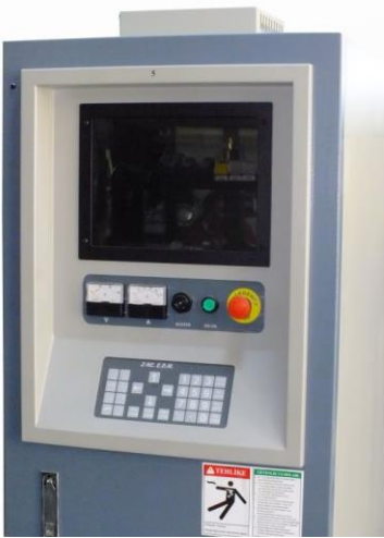
YENİ TİP ZNC KONTROL PANOSU
